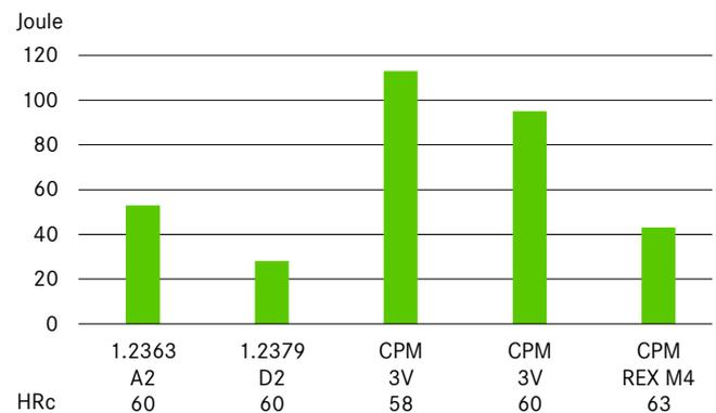
Charpy-C-notch-Probe mit einem Kerbradius von 12,7 mm.
