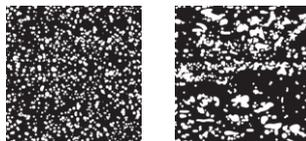
Das homogene pulvermetallurgisch hergestellte Gefüge verglichen mit der groben Karbidstruktur eines konventionell hergestellten Stahles.
