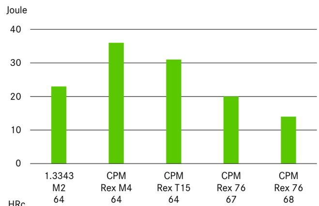
Charpy-C-notch-Probe mit einem Kerbradius von 12,7 mm.
